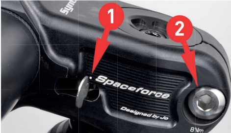
Abb.1: Arretierhebel und Fixierschraube am Spaceforce
