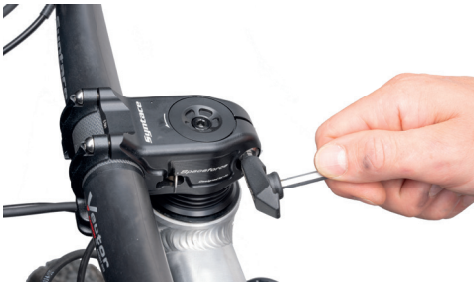
Abb.1: Leichtes Festziehen der Arretierschraube
