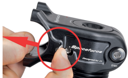
Abb.5: Zugang zur linken Baseclamp Schraube
