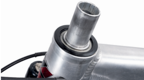
Abb.1: abgelängter Gabelschaft ohne Spacer
