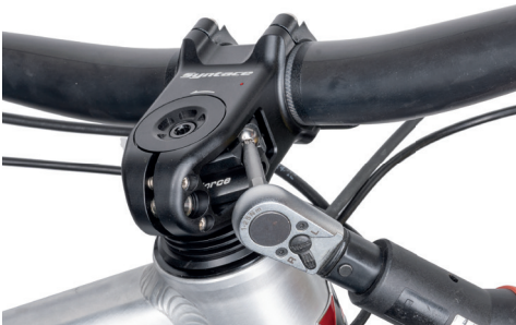
Abb.2: Anziehen der rechten Baseclamp Schraube
