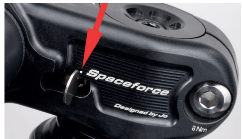
Abb.3: Richtig eingerasteter Spaceforce Vorbau
