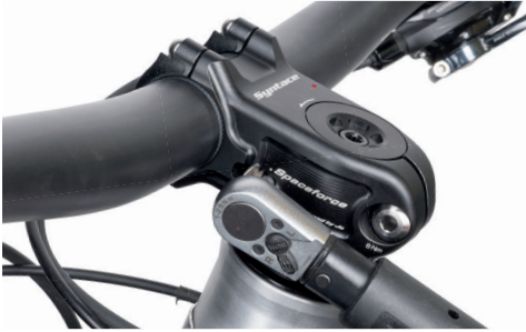
Abb.1: Anziehen der linken Baseclamp Schraube
