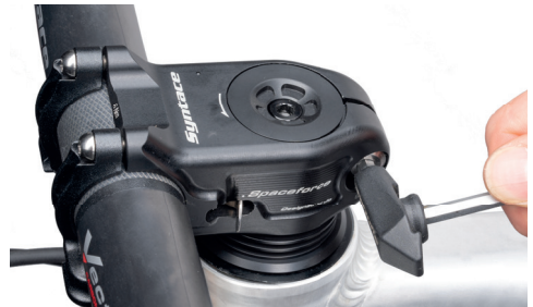
Abb.2: Handfestes anziehen der Arretierschraube (ca. 8 Nm)
