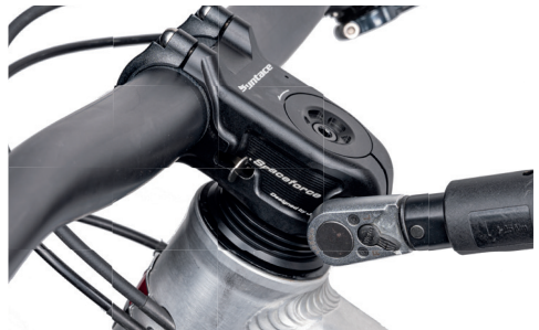
Abb.3: Anziehen der Fixierschraube mit 8 Nm
