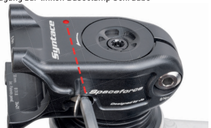
Abb.6: Anpeilen der linken Schraube der Baseclamp
