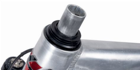
Abb.3: Gabelschaft mit Spacer Base und Spacer Top
